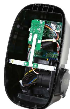
Obudowa chroniąca płytę PCB
